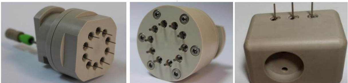
Multi-inyectores simple (izquierda), coaxial (centro) y lineal (derecha).
